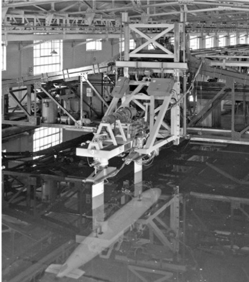
圖 3.8 垂向式之平面運動機構
