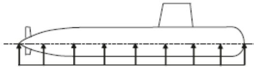
圖 3.24 (起伏與縱搖之混合運動) & 圖 3.25 (純起伏運動)
